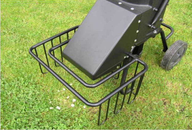
1 Eingreifschutz, Ansicht oben
