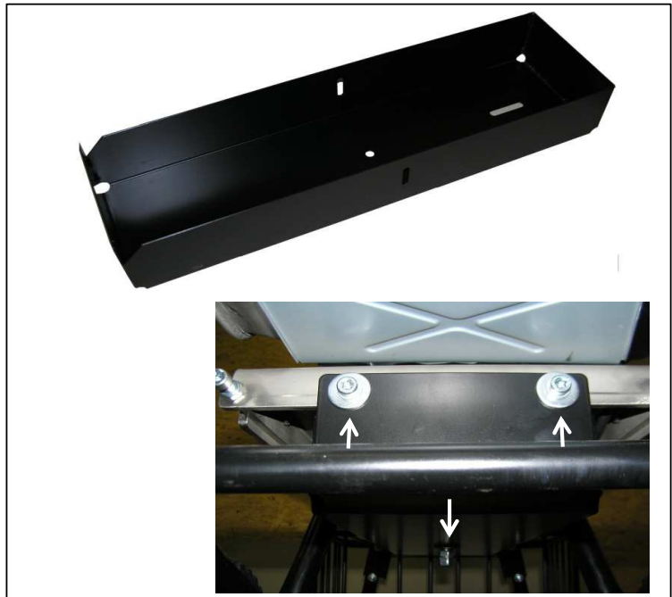
Bild 12: Keilriemenschutz, nur 3 Schrauben lösen
